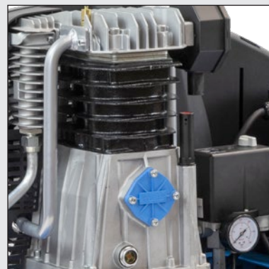
Špičkový dvojstupňový kompresor s tlakom 11 bar s medzichladičom
