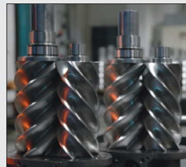
Skrutkový blok S67 s vysokým výkonom
