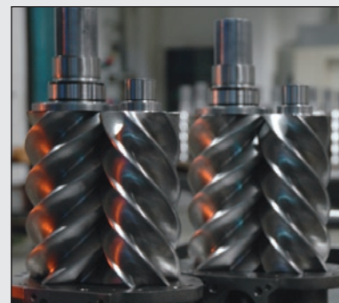
Skrutkový blok C55* s vysokým výkonom
